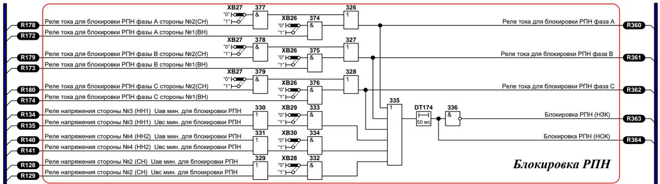
Рисунок 9 – Функциональная логическая схема блока логики блокировки РПН
