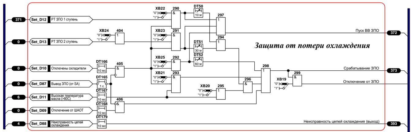
Рисунок 13 – Функциональная логическая схема блока логики ЗПО
