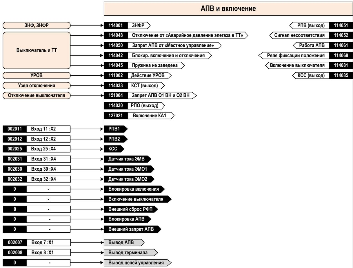
Рисунок 33.1 – Блок – схема узла АПВ и включение
