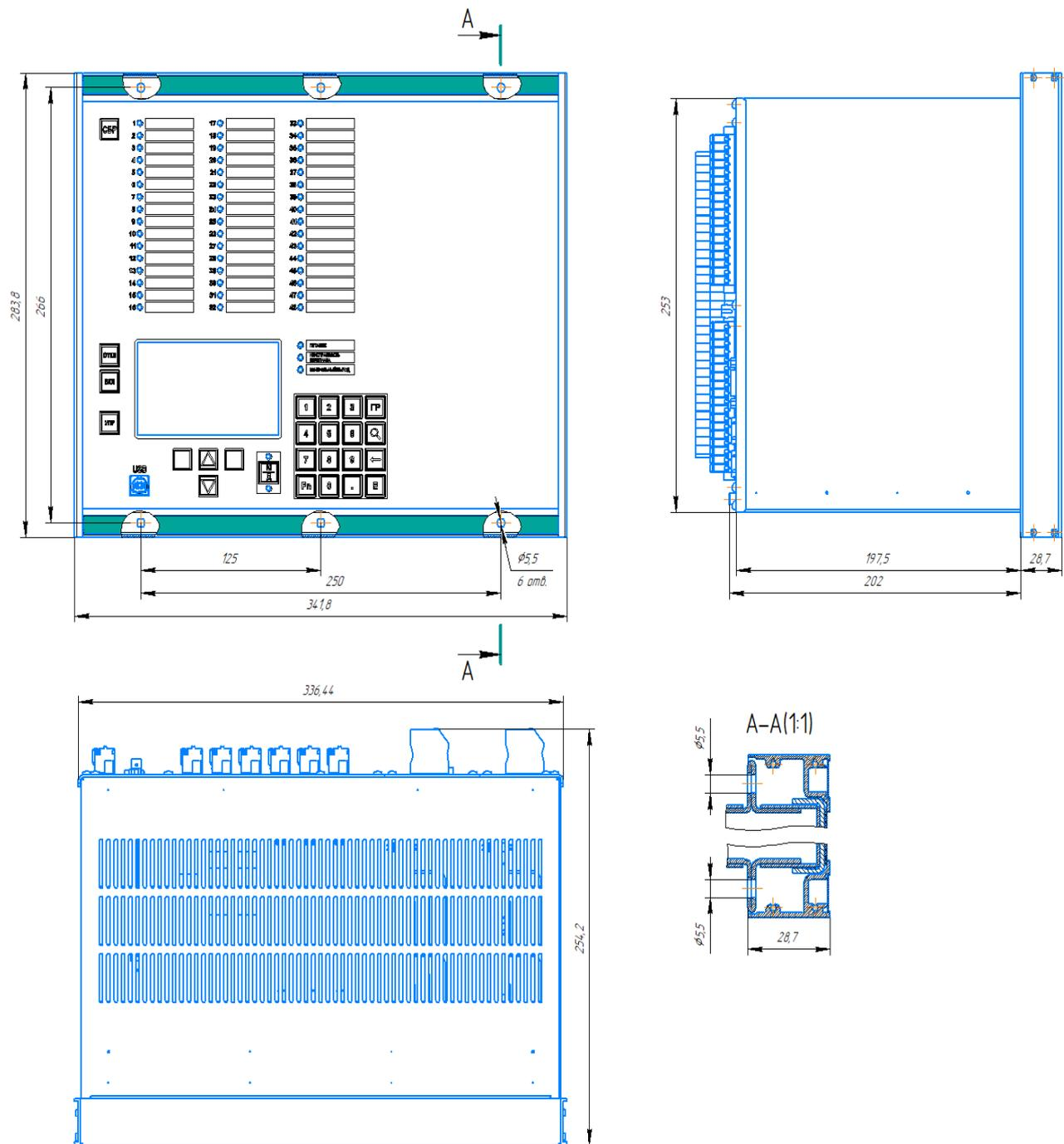
Рисунок 22 – Габаритные и установочные размеры терминала БЭ2704 308
