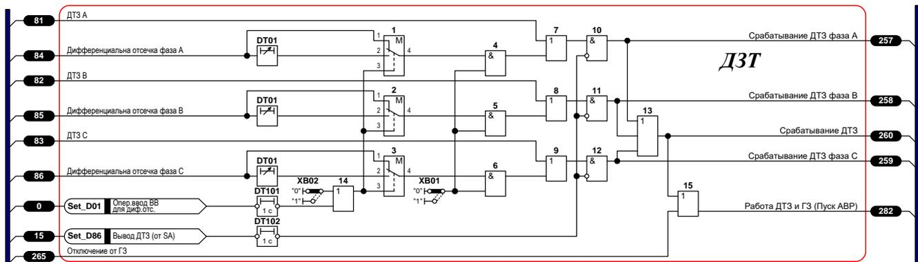
Рисунок 1 – Функциональная логическая схема блока логики ДТЗ
