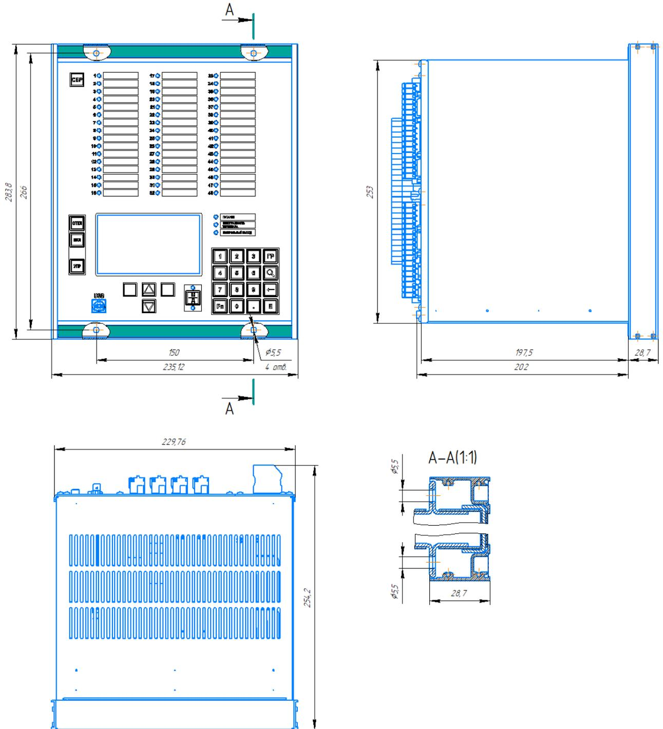
Рисунок 23 – Габаритные и установочные размеры терминала БЭ2704 207
