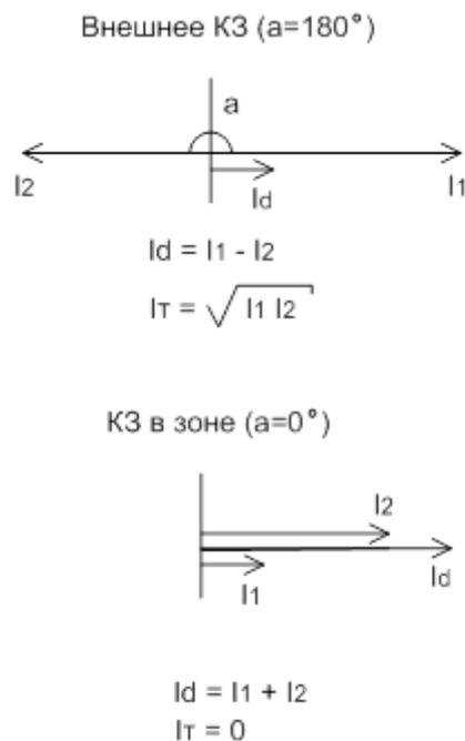
Рисунок 19.1 – Определение дифференциального и тормозного токов ДТЗ
