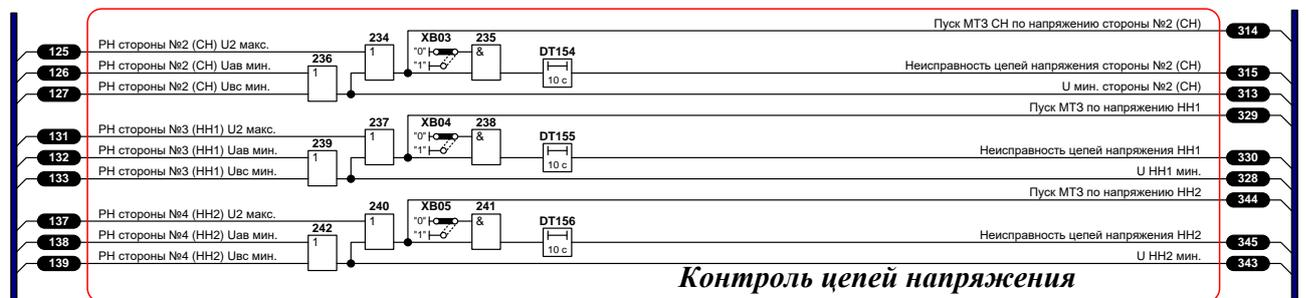
Рисунок 6 – Функциональная логическая схема блока логики контроля цепей напряжения
