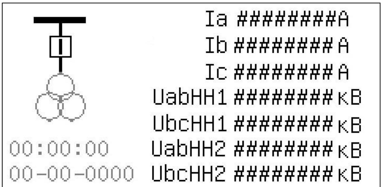
Рисунок 57 – Пример упрощённого изображения первичной схемы на графическом экране терминала
