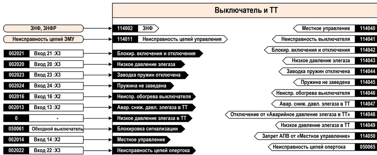
Рисунок 32.1 – Блок – схема узла Выключатель и ТТ
