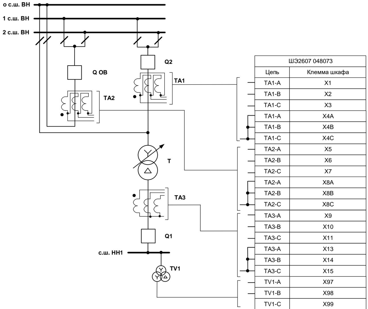
Рисунок 17.2 – Схема подключения комплекта защит №1 к цепям переменного тока и напряжения
