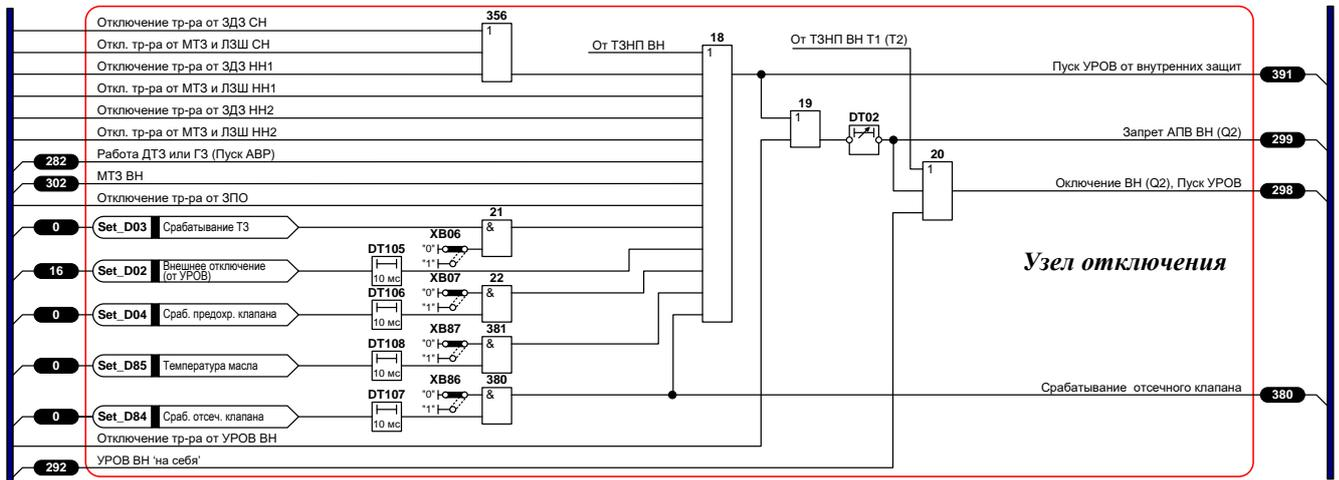
Рисунок 2. – Функциональная логическая схема узла отключения трансформатора
