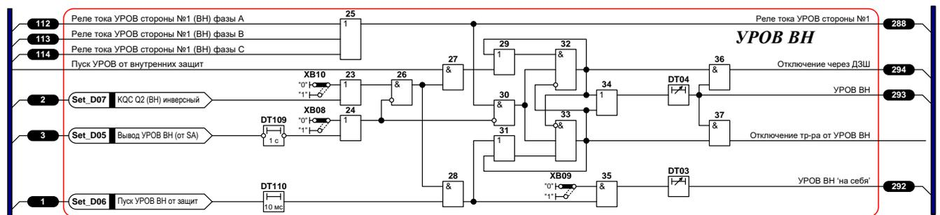
Рисунок 11 – Функциональная логическая схема блока логики УРОВ ВН
