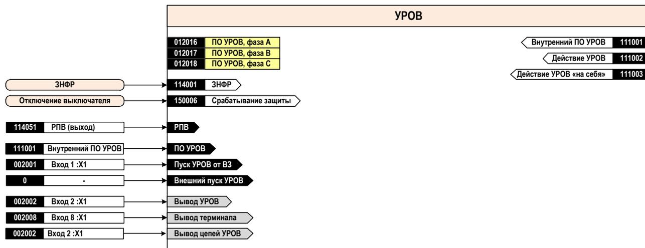
Рисунок 39.1 – Блок – схема узла УРОВ
