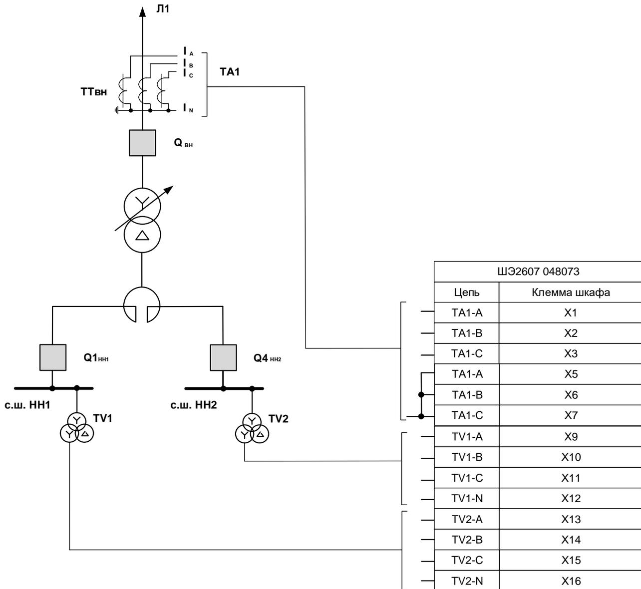
Рисунок 17.3 – Схема подключения комплекта защит №2 к цепям переменного тока и напряжения (один выключатель со стороны ВН)
