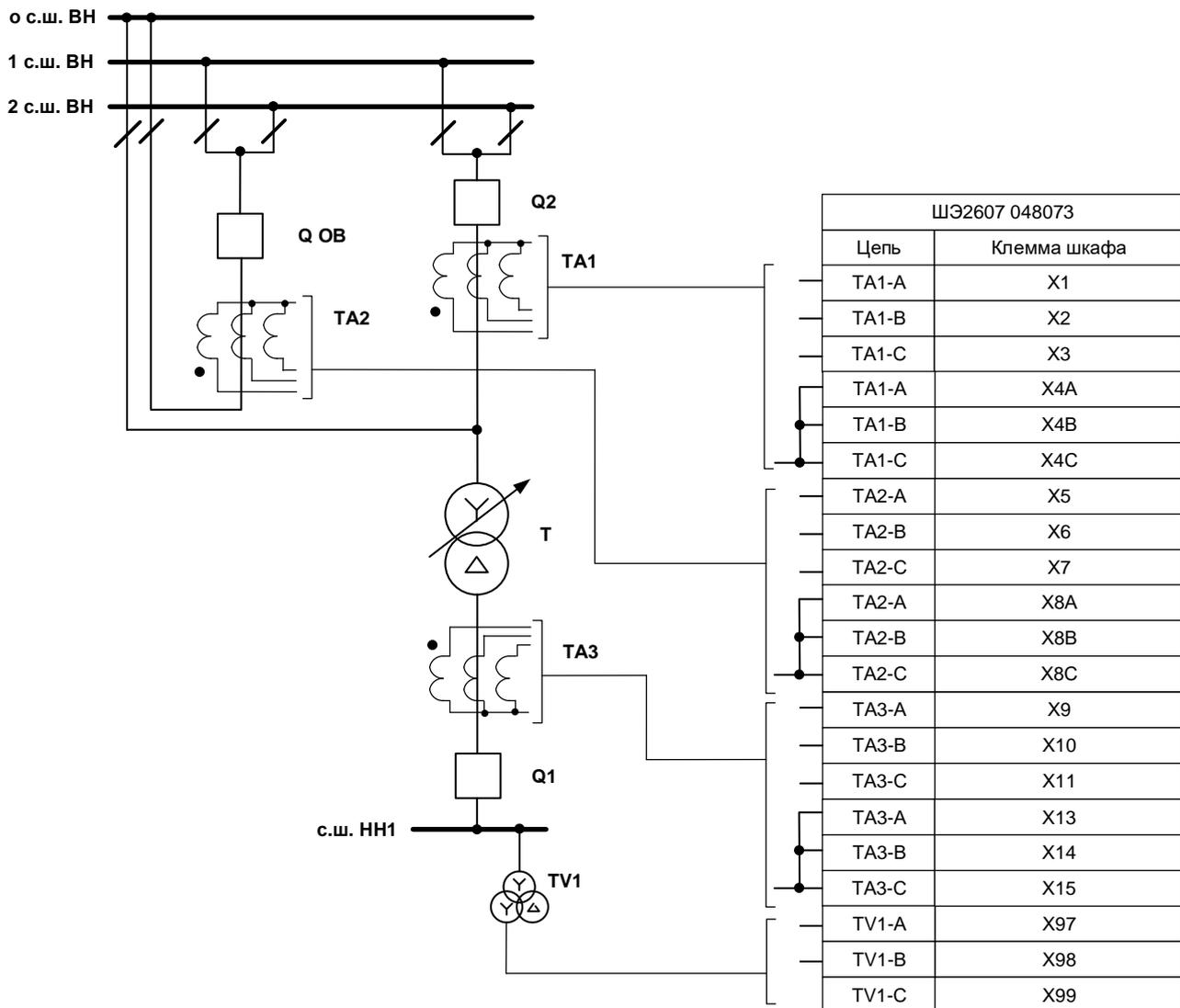
Рисунок 17.1 – Схема подключения комплекта защит №1 к цепям переменного тока и напряжения
