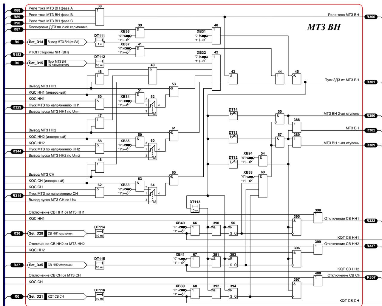
Рисунок 3 – Функциональная логическая схема блока логики МТЗ ВН
