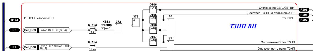
Рисунок 5 – Функциональная логическая схема блока логики ТЗНП ВН
