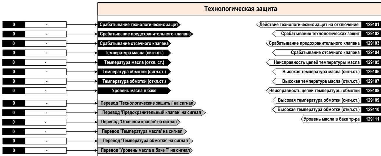
Рисунок 38.1 – Блок – схема узла технологической защиты
