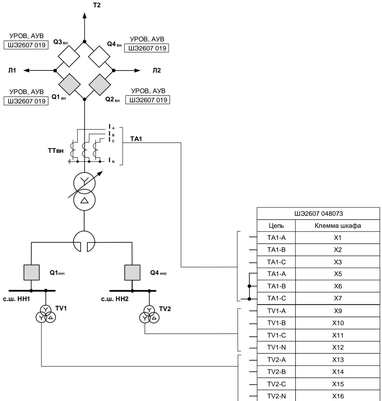
Рисунок 17.4 – Схема подключения комплекта защит №2 к цепям переменного тока и напряжения (два выключателя со стороны ВН)
