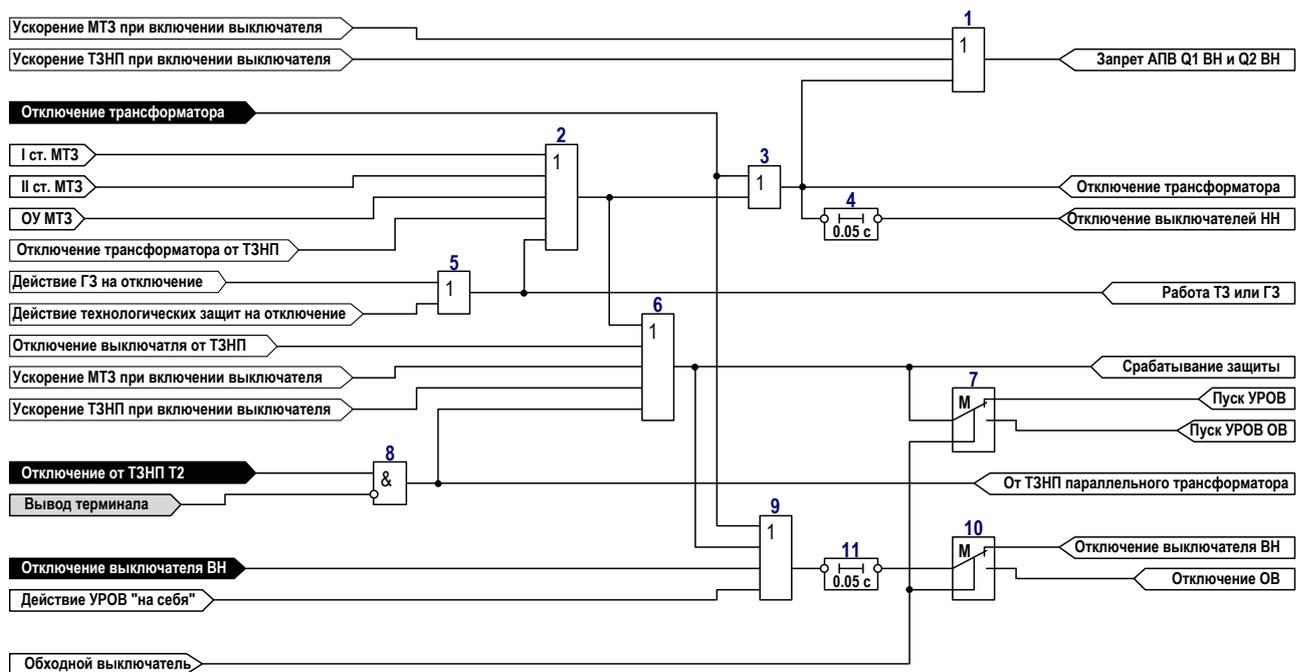
Рисунок 40.2 – Функциональная схема логической части узла отключения выключателя
