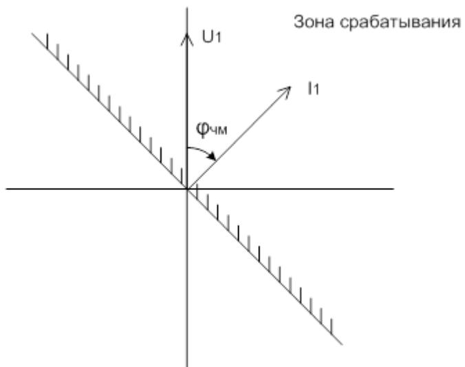
Рисунок 19.2 – Характеристика срабатывания РНМ МТЗ НН1
