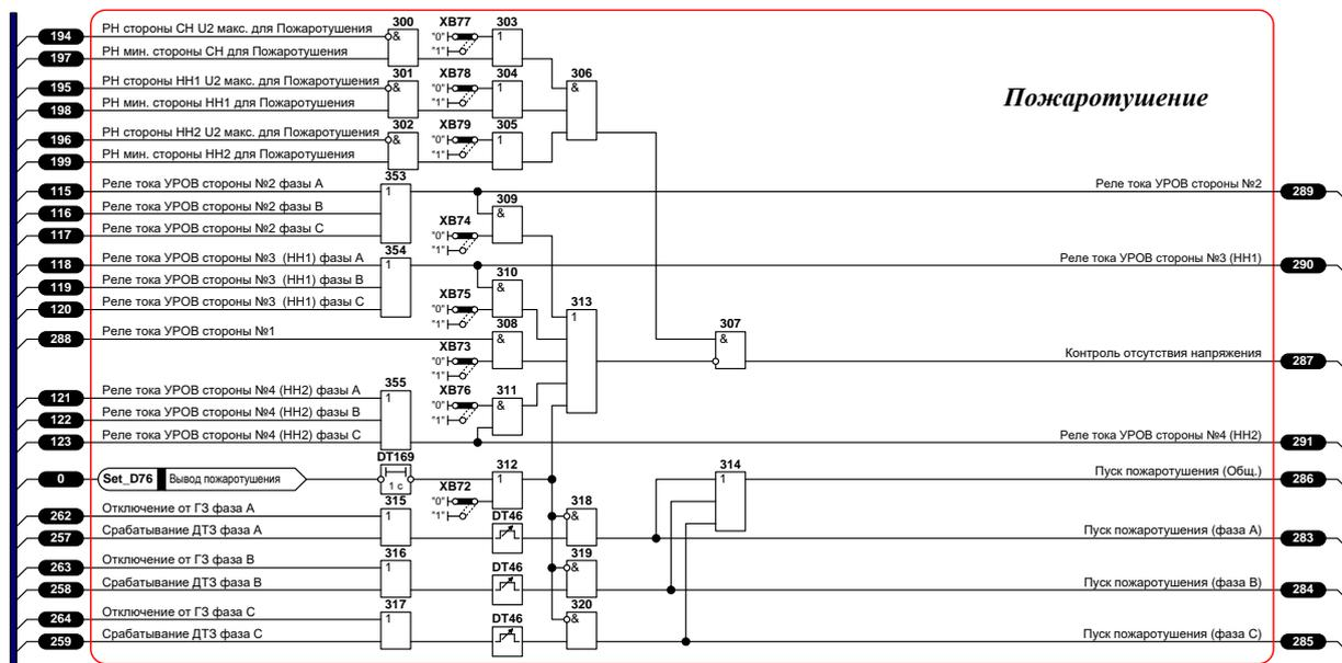
Рисунок 12 – Функциональная логическая схема блока логики пуска пожаротушения
